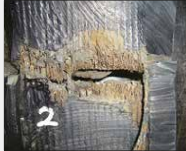
Stahlcordbruch aufgrund von Rost
