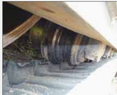
Detracking an einem Laufrad
