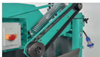
Getriebe mit drei gezahnten Trapezriemen und Keilscheiben.
