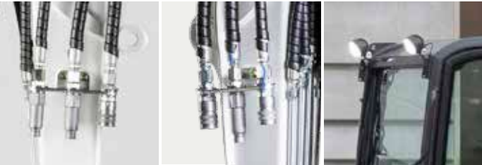
1. Zusatzhydraulik am Löffelstiel 2. Zusatzhydraulik Zusätzliche Beleuchtung (2+1)
