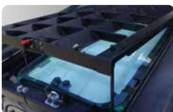
**FOPS-Schutzaufbau Stufe II**
