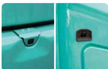
**Eingebaute Kamera hinten und rechts**
