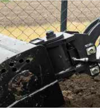
Mechanische Kupplung nach deutscher Bauweise (MS01) mit Kippfunktion
